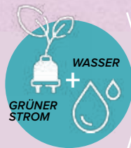
ELEKTROLYSE Wasser wird mithilfe von Strom in Wasserstoff und Sauerstoff zerlegt.
